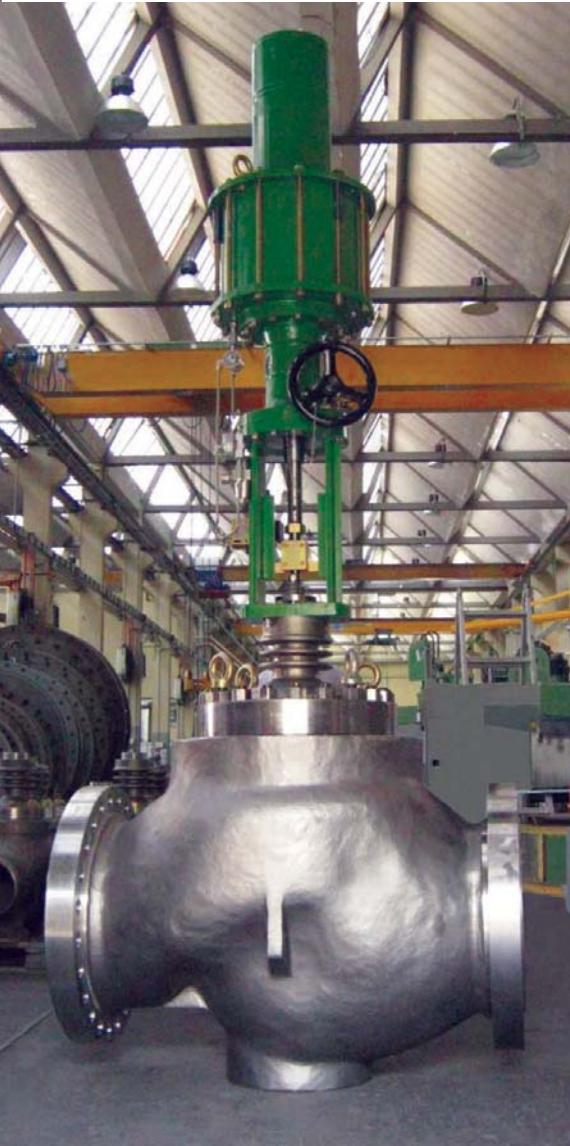
Valvola di controllo per servizio antipompaggio compressore ed alcuni renderings di valvole realizzate dagli ingegneri Parcol. Control valve for compressor antisurge service and some renderings of valves made by Parcol engineers.
